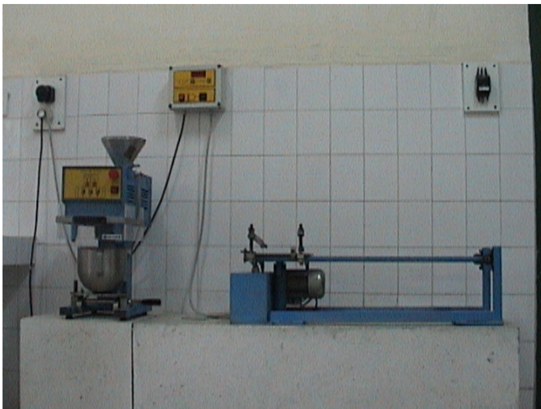
Hình 2.1. Máy trộn vữa xi măng và bàn dần đúc mẫu vữa xi măng
